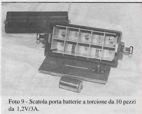
Foto 9 - Scatola porta batterie a torcione da 10 pezzi da 1,2V/3A.
